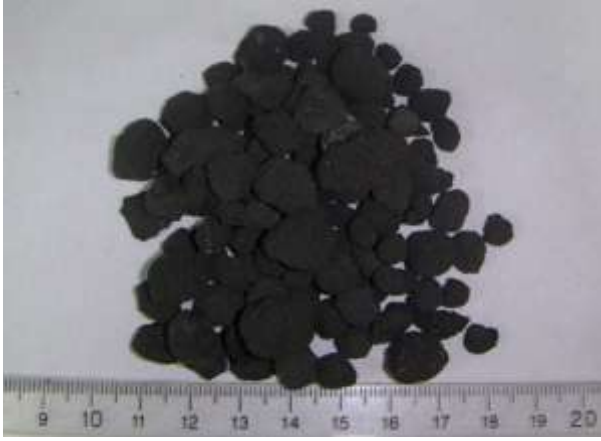
% 5 Tuzla Atık Çamur + % 95 LPG kullanılarak üretilen klinker numunesi
