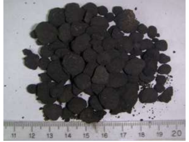
% 0 Atık Çamur + % 100 LPG kullanılarak üretilen klinker numunesi
