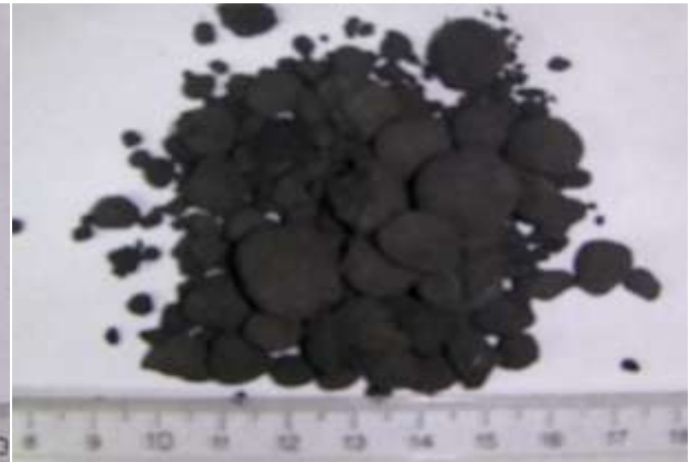
% 20 Paşaköy Atık Çamur + % 80 LPG kullanılarak üretilen klinker numunesi
