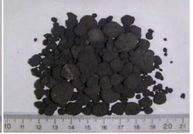
% 10 Tuzla Atık Çamur + % 90 LPG kullanılarak üretilen klinker numunesi
