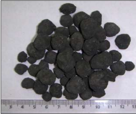
% 6 Ataköy Atık Çamur kullanılarak üretilen klinker numunesi
