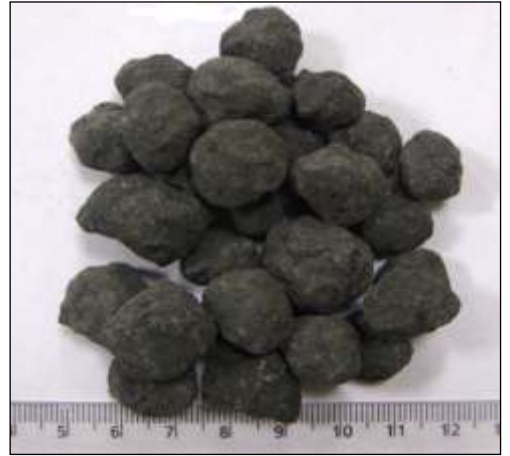
% 4 Ataköy Atık Çamur kullanılarak üretilen klinker numunesi
