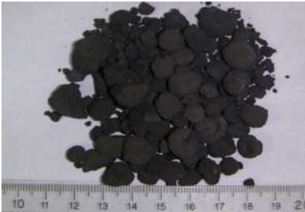
% 10 Paşaköy Atık Çamur + % 90 LPG kullanılarak üretilen klinker numunesi
