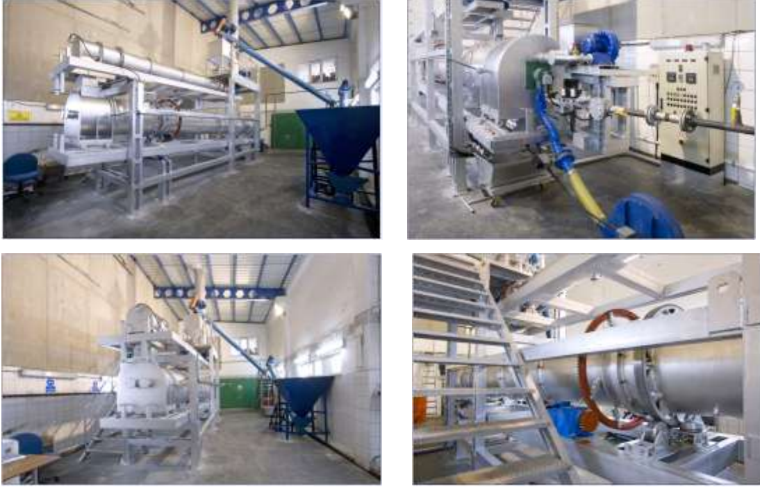
Şekil 4.1 Deneysel çalışmalar esnasında kullanılan pilot ölçekli çimento döner fırını
