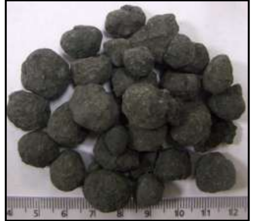
% 10 Paşaköy Atık Çamur kullanılarak üretilen klinker numunesi
