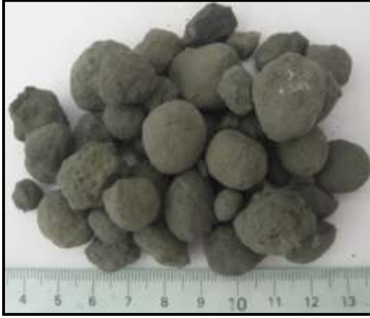
% 0 Atık Çamur kullanılarak üretilen klinker numunesi
