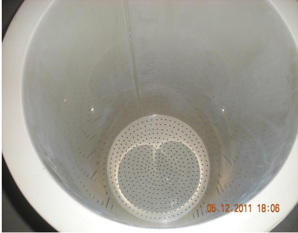
Şekil 3. 3 Reaktör tabanında bulunan 1 cm çaplı delikli polipropilen tabaka
