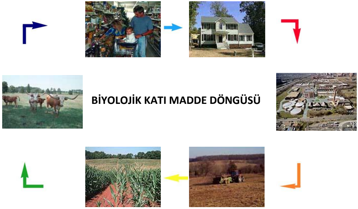
Şekil 2. 7 Arıtma çamurlarının gübre olarak kullanılması halinde oluşan katı madde döngüsü [14]
