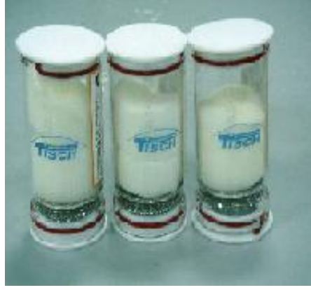
Şekil 3.7 PUF(Poliüretan köpük) ve cam kartuş düzeneği
