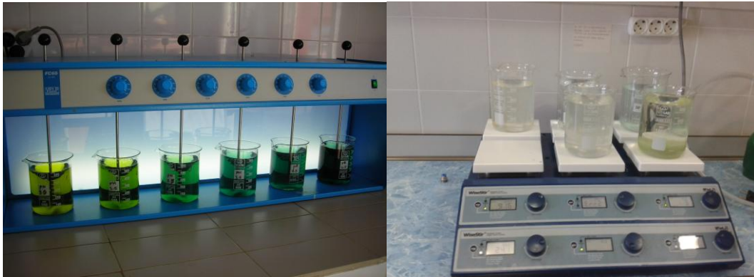
Şekil 3.2 Jar test düzeneği
