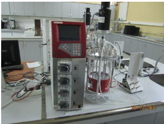
Şekil 3.2 Fermentör düzeneğinin fonksiyonları (a) Karıştırma sistemi, (b) Bombeli tabanı sıvı kabı, (c) Giriş ve çıkışların yapıldığı portlar, (d) Kontrol paneli ve (e) Pompalar
