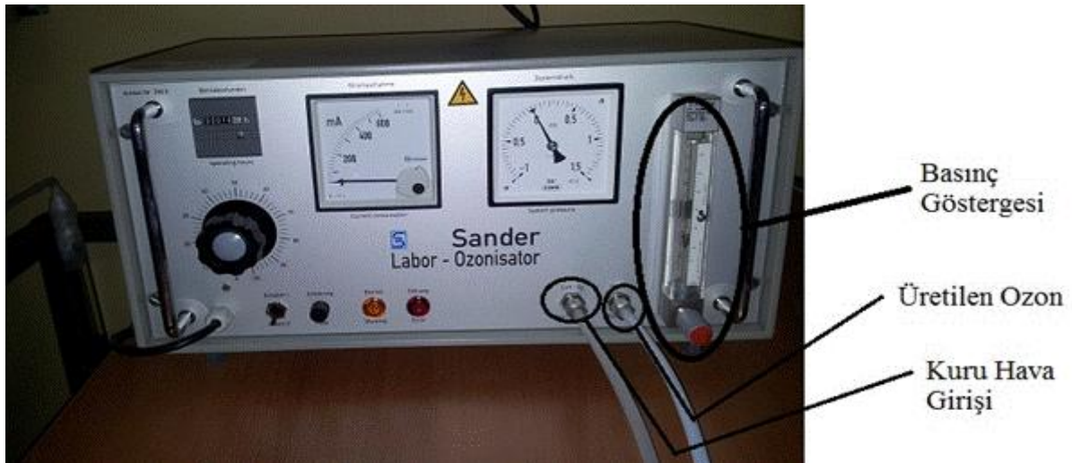
Şekil 3.11 Ozon jeneratörü (Sander Laboratory Ozonizer 300.5)
