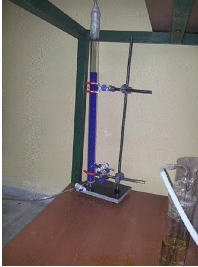
Şekil 3.7 Ozon jeneratörü öncesinde kullanılan silika jel kolonu
