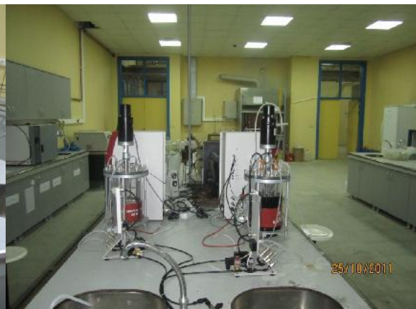
Şekil 3.2 Fermentör düzeneğinin fonksiyonları (a) Karıştırma sistemi, (b) Bombeli tabanı sıvı kabı, (c) Giriş ve çıkışların yapıldığı portlar, (d) Kontrol paneli ve (e) Pompalar
