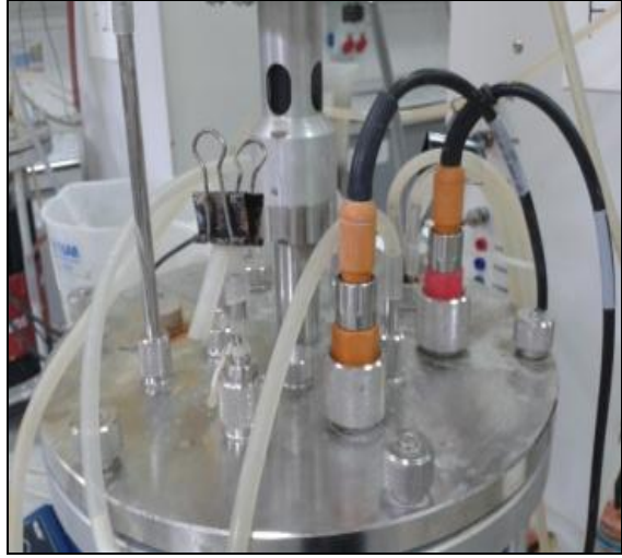
Şekil 3.10 Fermentördeki pH, ORP, ÇO ve sıcaklık propları
