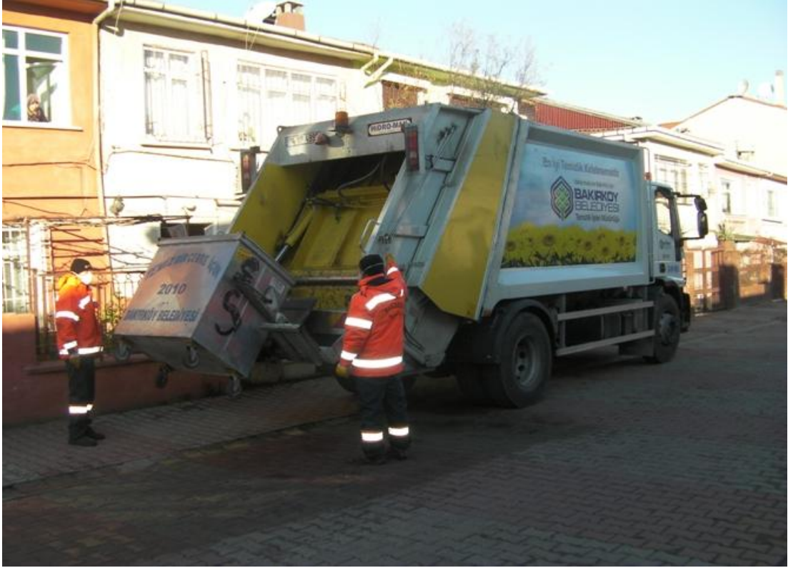
Şekil 4.1 Kentsel katı atıkların toplanmasında kullanılan 15+1,5 m 3 kapasiteli araç
