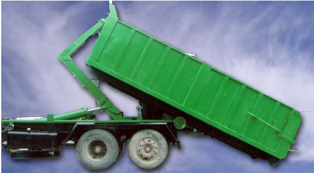
Şekil 3.3 Atık kağıtların toplanmasında kullanılan hareketli konteynır teçhizatı
