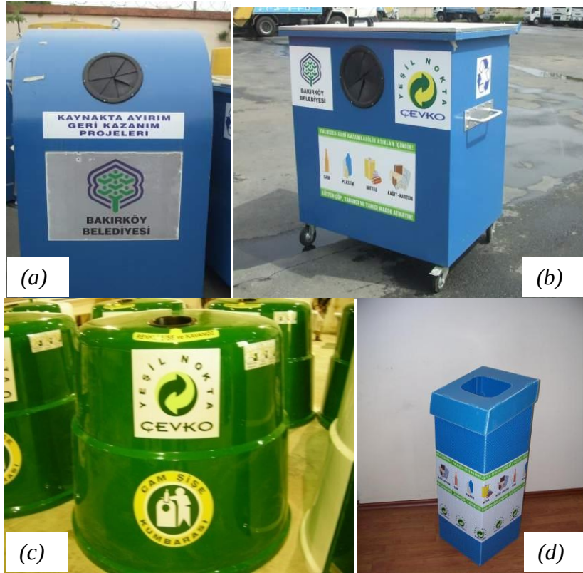
Şekil 5.4 İlçede gerikazanılabilir atıkların toplanmasında kullanılan donanımlar (a:1000 L kapasiteli 4 gözlü kumbara, b: 700 L kapasiteli konteynır, c: Atık cam kumbarası, d: İç mekan kutusu)
