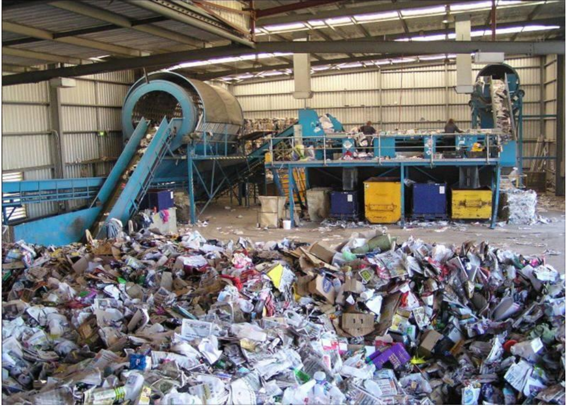
Şekil 5.8 Toplama ayırma tesisinde döner elek ve ayırma bandı
