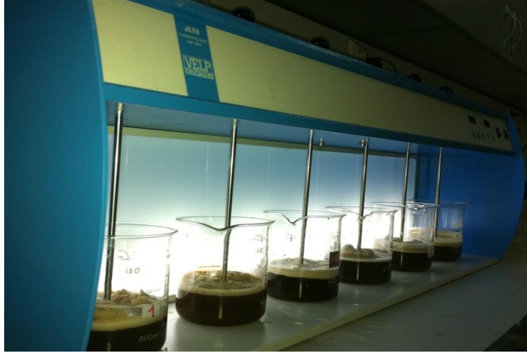
Şekil 5.11 Fenton oksidasyonlarının yapıldığı jar test düzeneği
