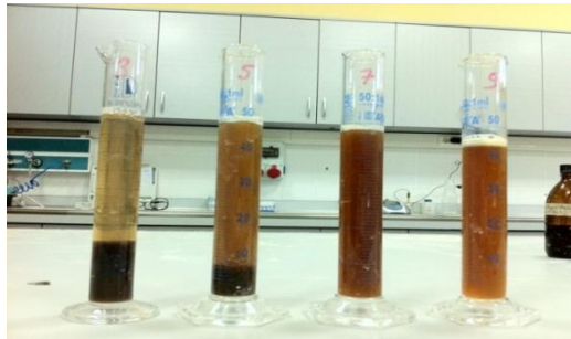
Şekil 6.2 Çöktürme için farklı pH değerlerinin etkisi ( soldan sağa pH 3,5,7 ve 9)
