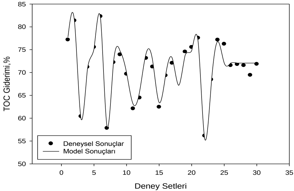
Şekil 6.7 Fenton Prosesi ile orta yaşlı sızıntı suyu TOK giderim verimi deneysel sonuçlar ve model sonuçları
