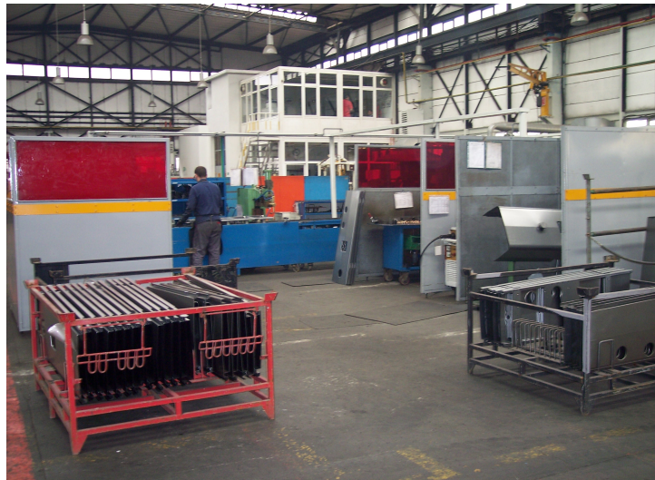
Şekil 6.17 Eski ve U hattına dönüştürülmüş kaput hücresi
