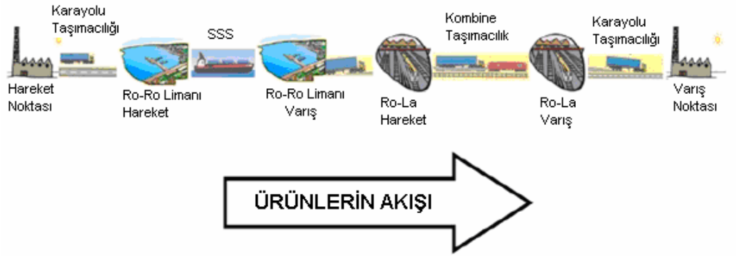
Şekil 5.1 İntermodal yapı içerisinde ürünlerin akışı (Atılğan, 2005)
