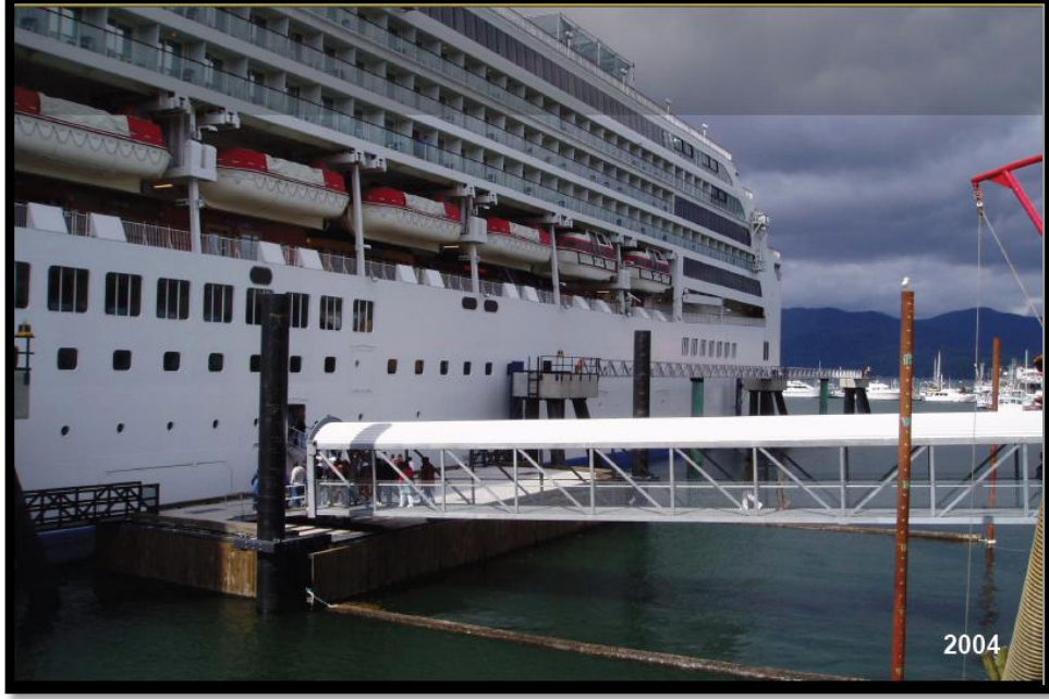
Fotoğraf 4.7 Yolcu nakliyesi için kullanılan körük sistemleri (Levis [15])
