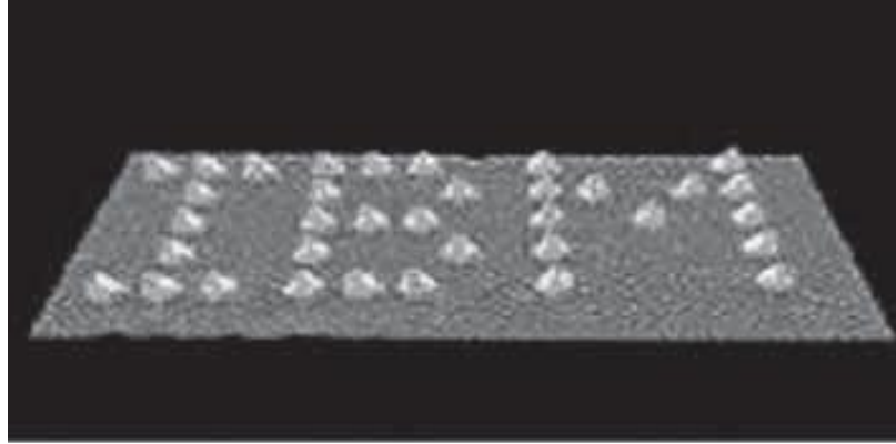
Şekil 2. 8 Ksenon atomuyla hecelenmiş olan IBM logosu, 1989
