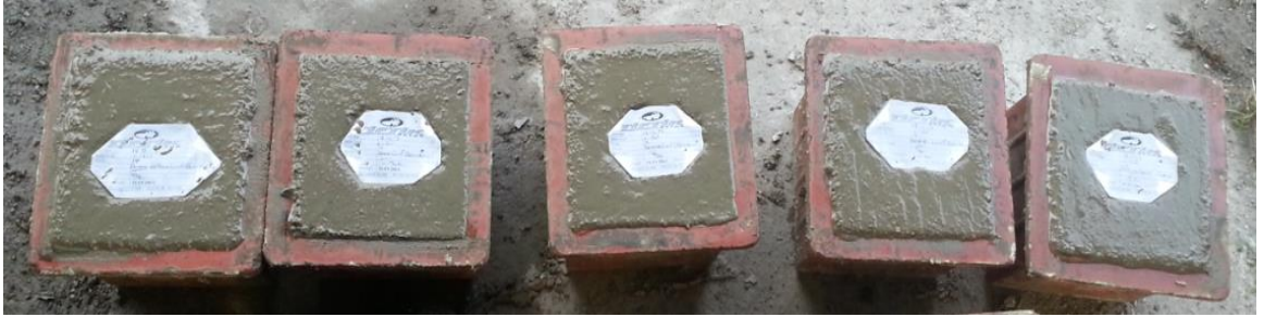
Şekil 7.3 Küp kalıba yerleştirilmiş beton numuneleri
