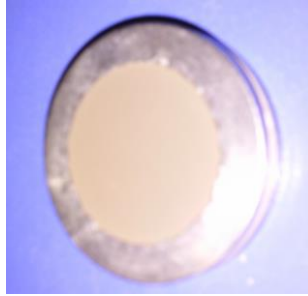
Şekil 6.7 Preslenerek tablet haline getirilmiş çelikhane cüruf numunesi
