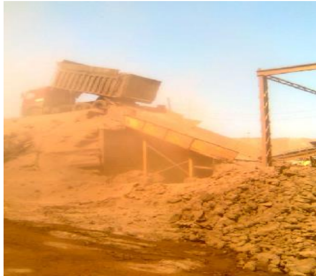
Şekil 5.3 Yatay eleğin yandan görünüşü (+55 mm)
