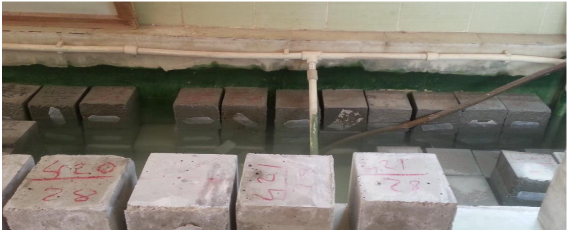
Şekil 7.4 Beton numunelerinin bekletildiği 23\pm 2^{\circ}\text{C} 'de ayarlı kür havuzu
