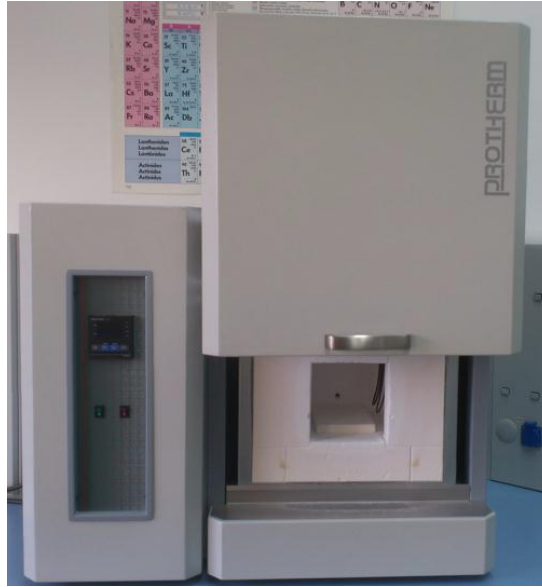
Şekil 3. 6 Protherm marka, MOS 180/4 model yüksek sıcaklık fırını
