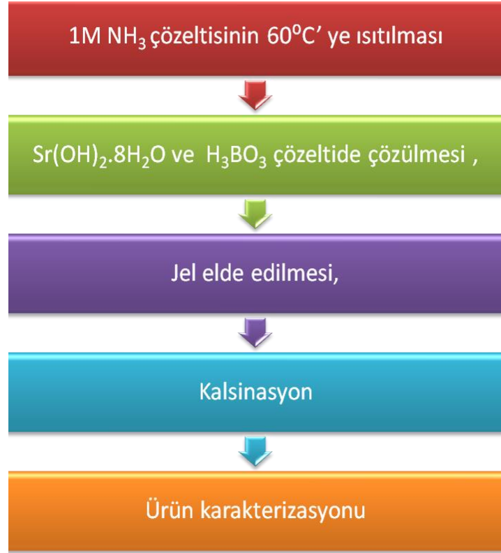
Şekil 4. 7 Mineral sol-jel yöntemi akış şeması
