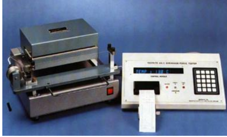
Şekil 5.5 % kısıalma ölçüm cihazı (Testrite)
