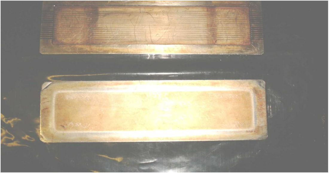
Şekil 5.10 Tek kord şerit yapışma testinde kullanılan numune hazırlama kalıbı
