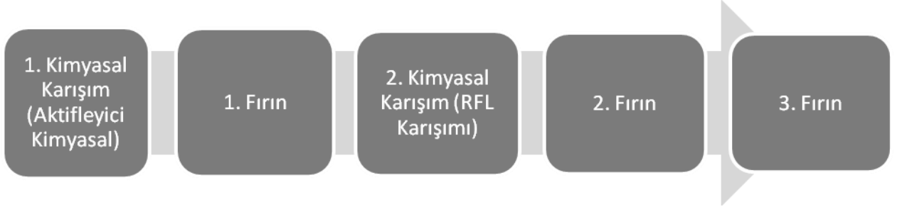
Şekil 5.2 Kordun computreater cihazı içerisinde izlediği yol
