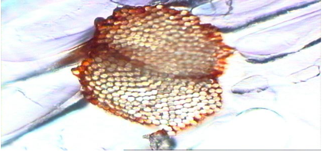
Şekil 3.3 Banyoya daldırılarak yüzeyi kimyasal ile kaplanmış kord (lif demeti) kesiti
