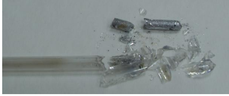
Şekil 5.12 Üretimin ardından kırılan kuvars tüp ve elde edilen yarıiletken alaşım
