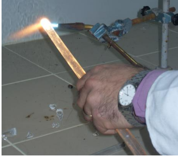
Şekil 5.8 Asetilen oksijen kaynağı ile kapatılmakta olan kuvars tüpler
