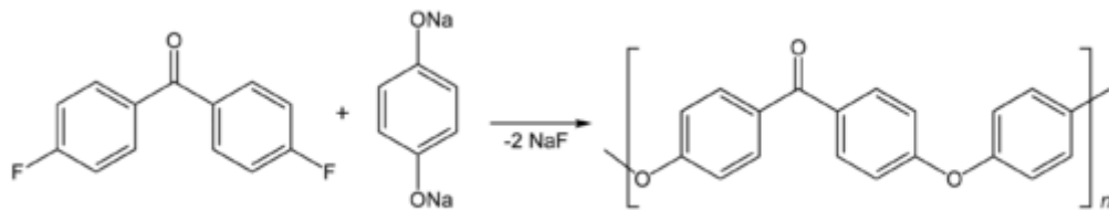
Şekil 3.2 PEEK'in kimyasal yapısı [50]
