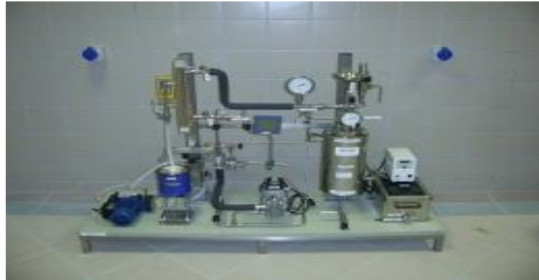
Şekil 2.19 Bir pervaporasyon düzeneği [38]
