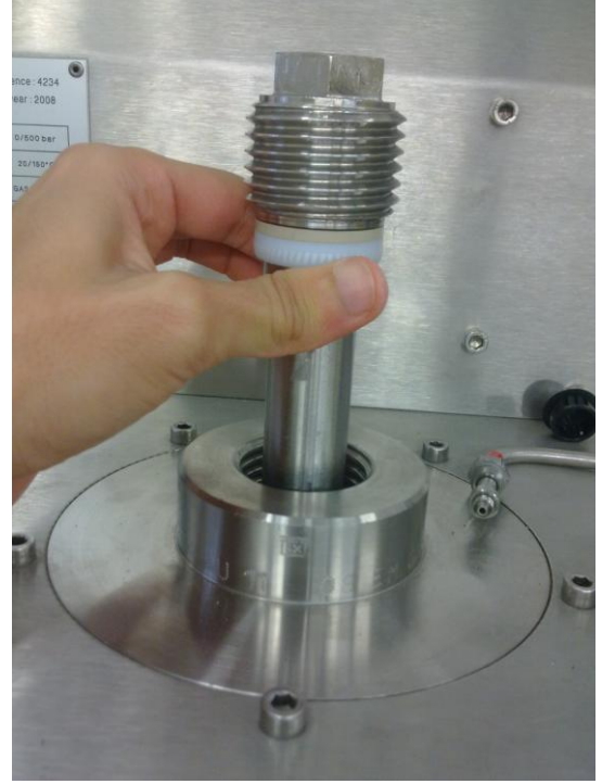
b) Ekstraktörün ısıtma ceketine yerleştirilmesi
