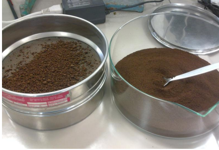
Şekil 3.2 Kurutulmuş kahve telvelerinin elekten geçirilmesi
