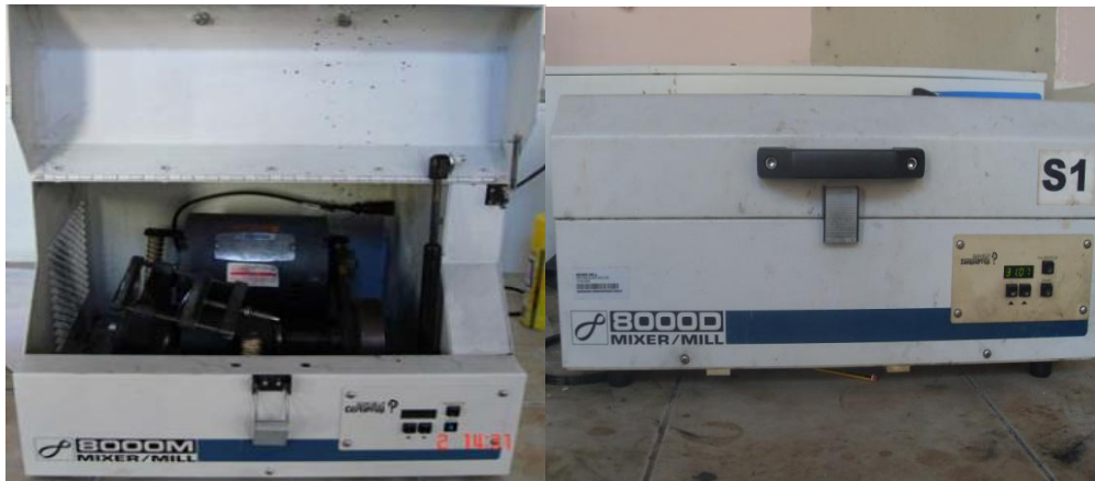
Şekil 3.16 Mekanik alaşımlamada kullanılan yüksek enerjili bilyalı öğütücü, Spex™ Mixer/Mill
