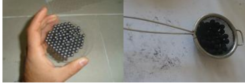
Şekil 7.4 Öğütme işleminde kullanılan bilyeler ve öğütme sonrası üzerinde kalan alaşım tozları. (Bilyelerin önceki ve sonraki durumları)
