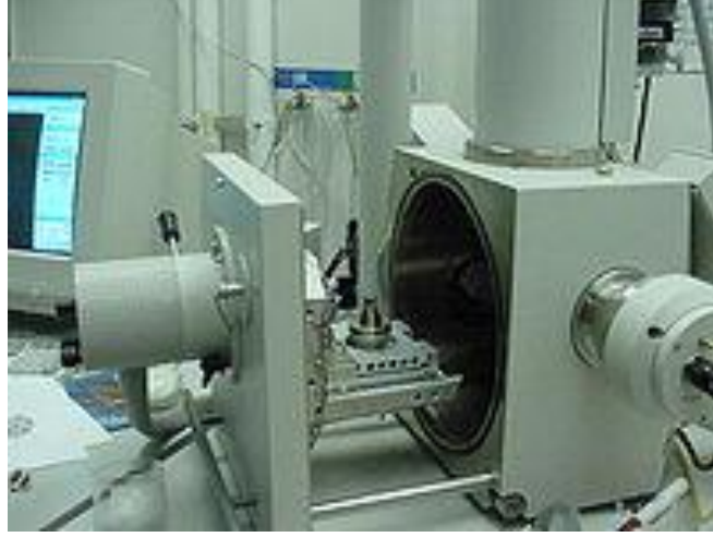
Şekil 6.8 Taramalı Elektron Mikroskopunun vakum odasının görüntüsü [69]
