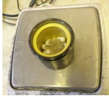
Şekil 7.16 Öğütme Haznesinde Bilya ve Tozların Yerleşim Düzeni
