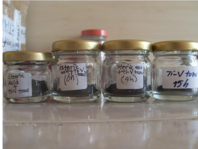
Şekil 7.5 Atık Ti6Al4V talaşlarından alınarak sırası ile 3, 6, 9, ve 15 saat öğütülmüş numuneler
