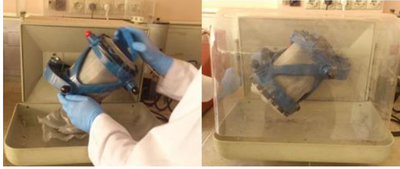
Şekil 7.13 Numunelerin Turbula Mixer'a Yerleştirilmesi-Homojen Karıştırma İşlemi Turbuladan çıkan malzeme Fritsch™ Premium line Pulverisette 7 tipi öğütücüde kuru karıştırma yöntemi ile öğütülmüştür. Öğütücü modeli Şekil 7.14'de verilmektedir.
