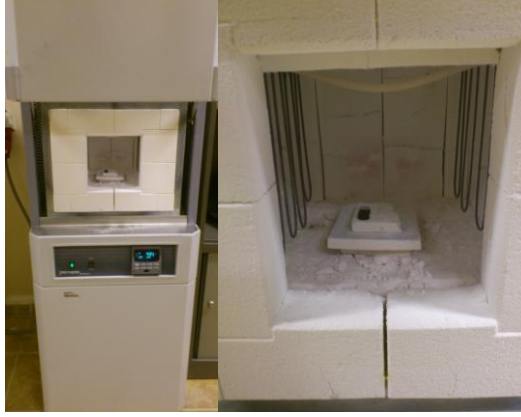
Şekil 7.19 Protherm™ Fırın ve Malzemelerin Yerleştirilmesi
