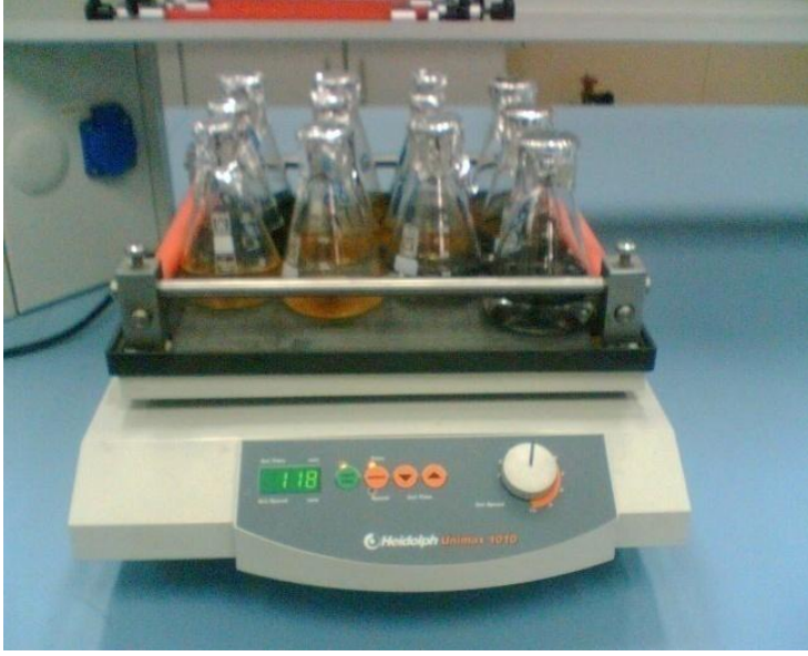
Şekil 4.4 Orbital çalkalayıcıda (Heidolph Unimax 1010) ve kolonda gerçekleştirilen deneyler
