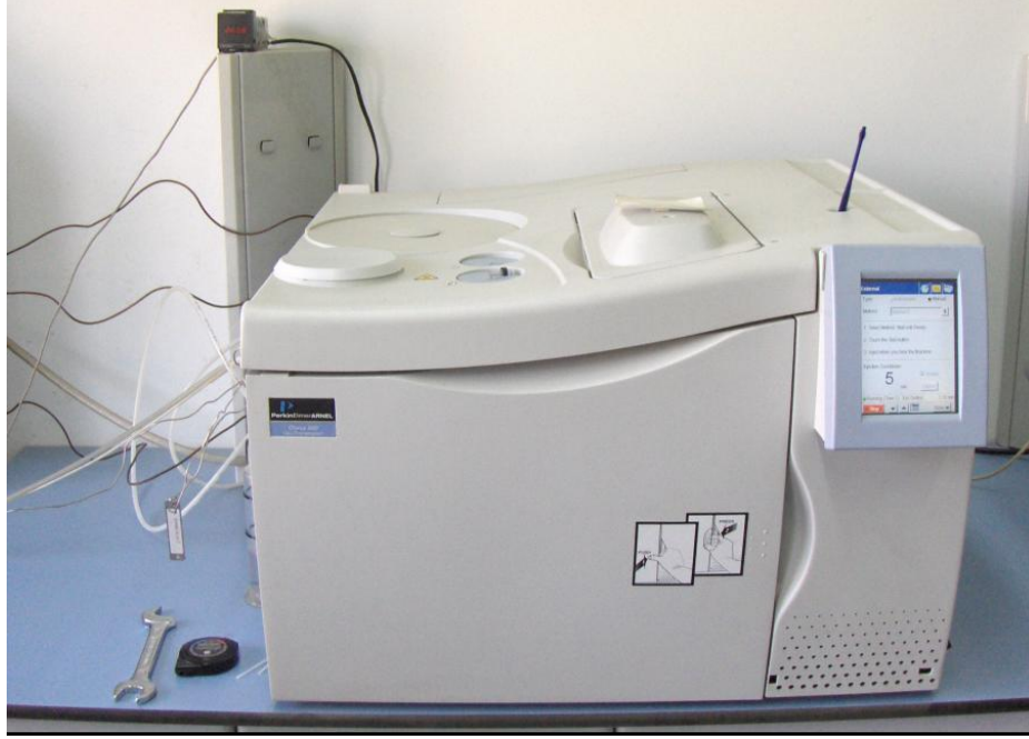
Şekil 5.2 Gaz kompozisyonlarının belirlenmesinde kullanılan cihaz
