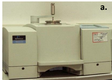
Şekil 5. 3 a. FT-IR, b. Raman Spektroskopisi
