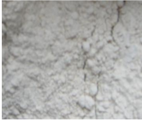
Şekil 6. 1 Deneylerde kullanılan klinoptilolit
