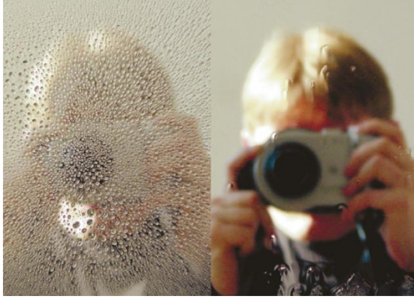
Şekil 3.2 Kaplamasız (sol) ve hidrofilik kaplama (sağ) ile kaplanmış ayna [1]
