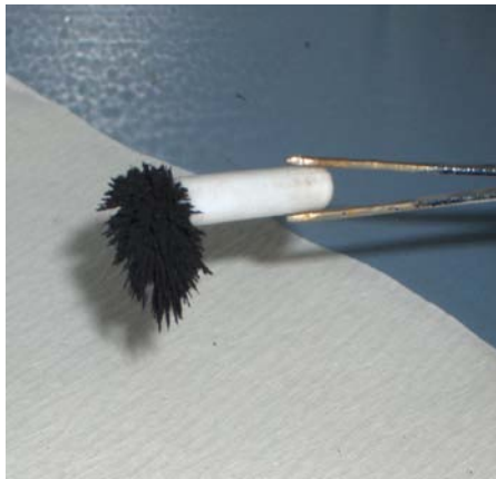
Şekil 6.3 Oluşan partiküllerin manyetik özelliği
