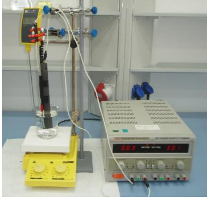
Şekil 6.1 Zirkonyumun oksit tabakası kaplanması için kurulan deney düzeneği (Şen, 2010).
