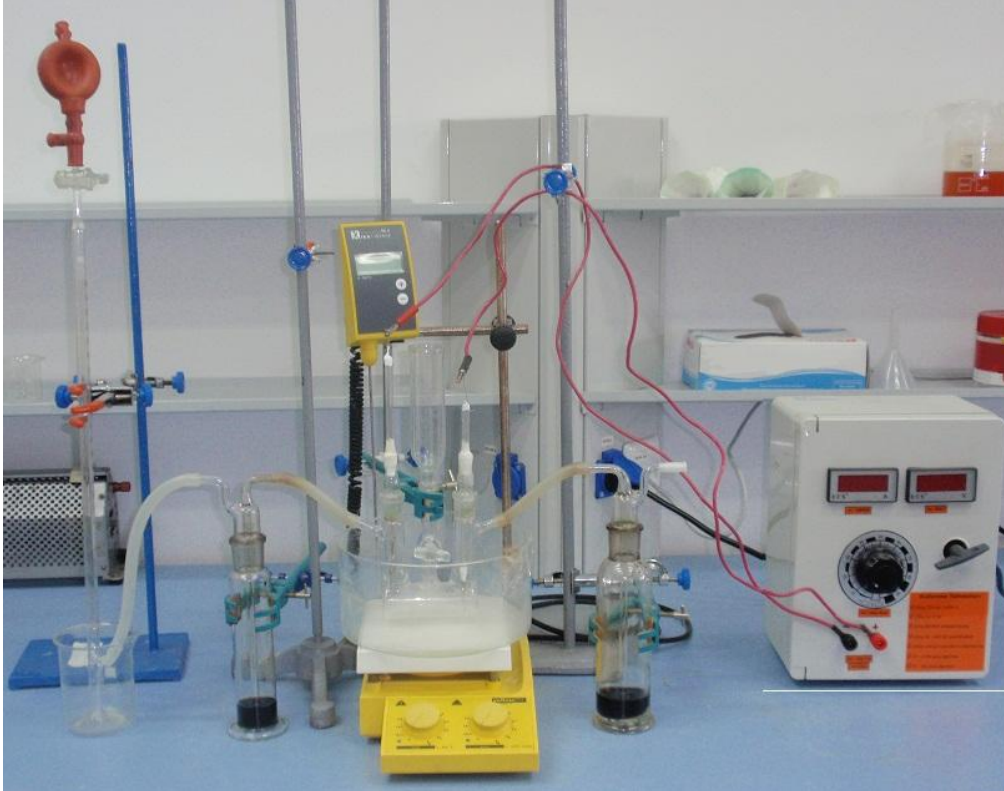
Şekil 6.3 Suyun elektrolizi için kullanılan deney düzeneği.
