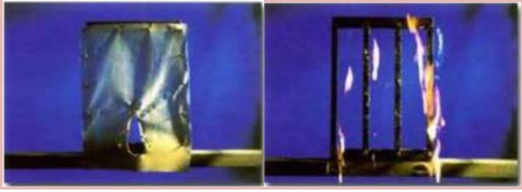
Şekil 5.4 Alev geciktirici katkılı ve katkısız polietilen film yanma testi (Tektaş ve Mergen, 2003)
