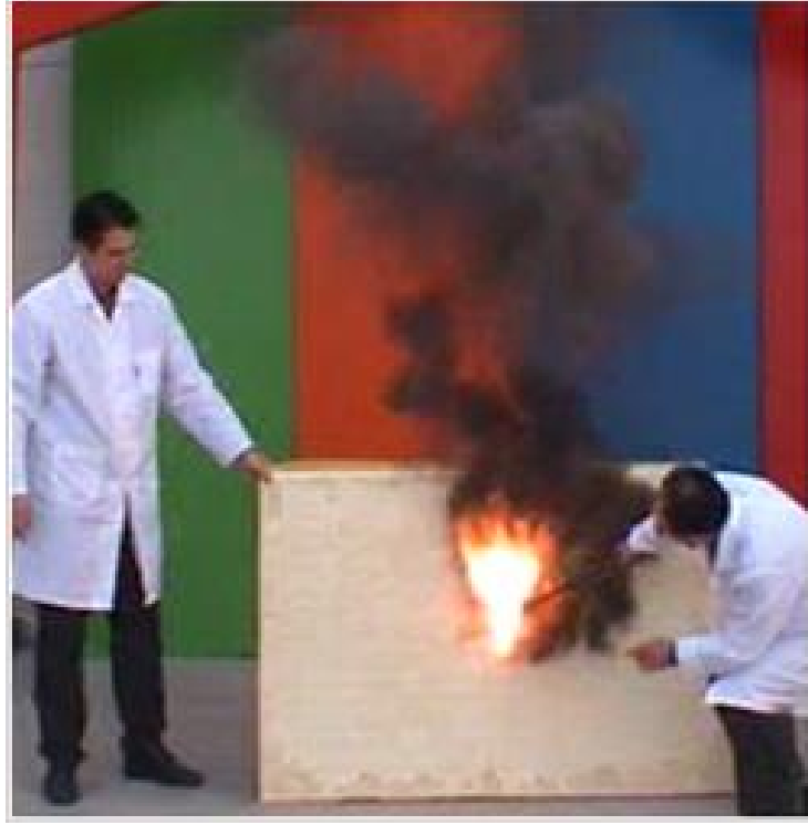
Şekil 5.3 Alev geciktirici katkı ve katkısız yatak yanma testi [14]
