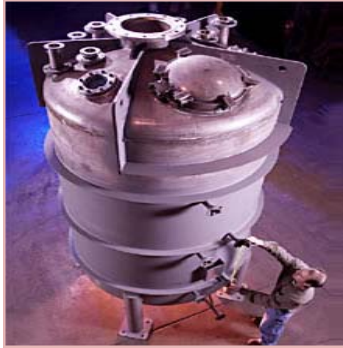
Şekil 3.8 Borik asit reaksiyonunun gerçekleştiği reaktör (Kılıç, 2005)
