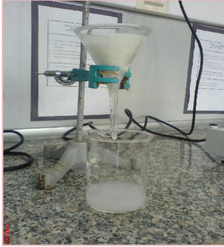
Şekil 6.1 Ayırma aparatlı deney düzeneğinde \text{CaSO}_4 ve \text{Na}_2\text{SO}_4 maddelerinin ayrılması
