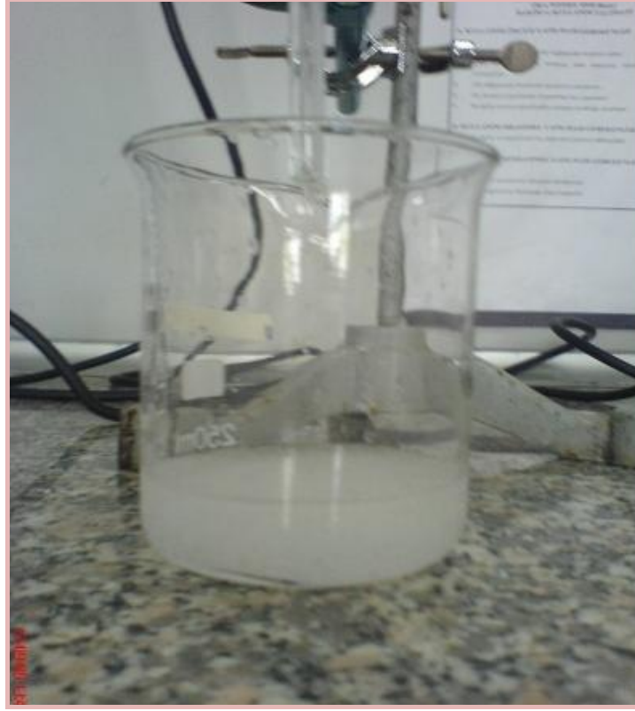
Şekil 6.2 Boraks dekahidrat ile sentezlenen borik asit kristalleşmesi
