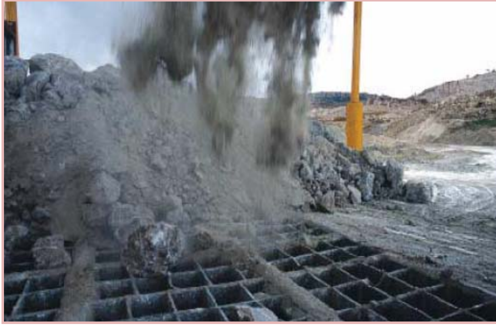
Şekil 2.3 Madenden getirilen boraks minerali dev eleklerle dökülürken (Kılıç, 2005)
