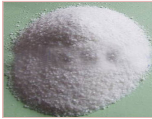
Şekil 5.1 Çinko Boratın fiziksel görünüşü [13]
