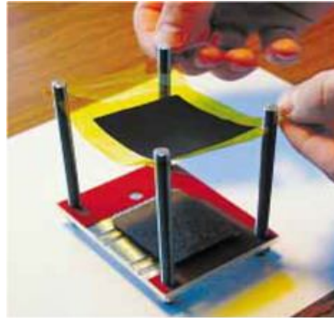
Şekil 2.9 Bir membranın yığın içine yerleştirilmesi [5]
