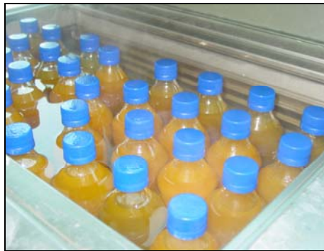
Şekil 7. 3 Hazırlanan meyveli içeceklerin pastörizasyonu
