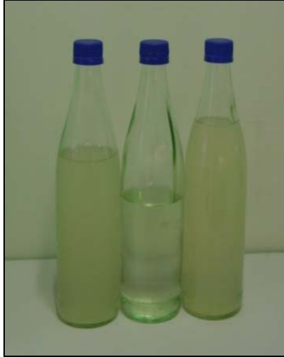
Şekil 7.1 Guar gum, CMC ve keçi boynuzu gamı ile hazırlanan çözelti örnekleri
