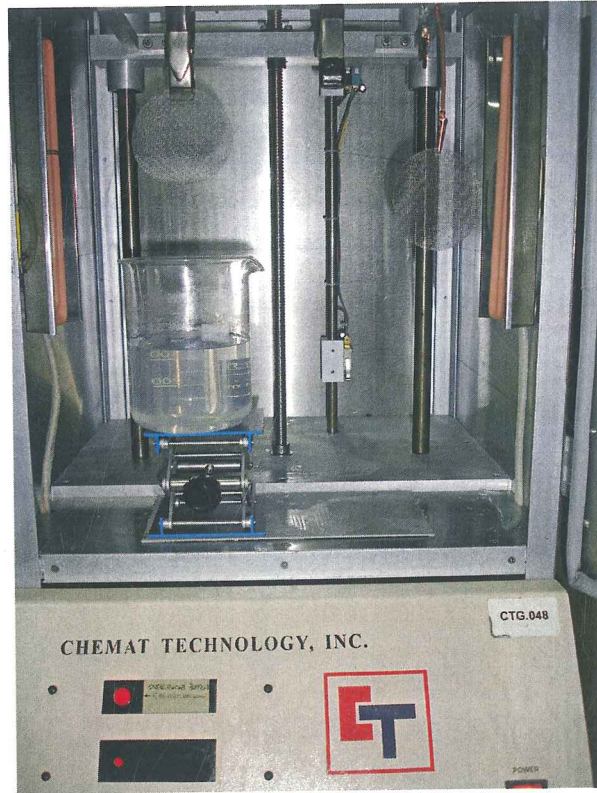
Şekil 11.5.3.2 Paslanmaz çelik tel kafeslerin daldırma yöntemiyle kaplanması
