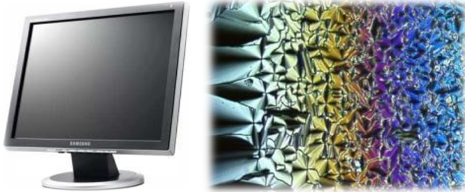
Şekil 3.5 Sıvı kristal ekran ve içyapısı [8; 9]
