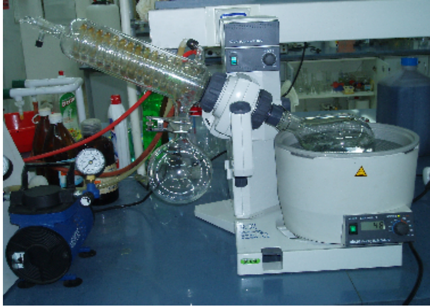
Şekil 6.3 Fazla alkolün uzaklaştırıldığı döner buharlaştırıcı
