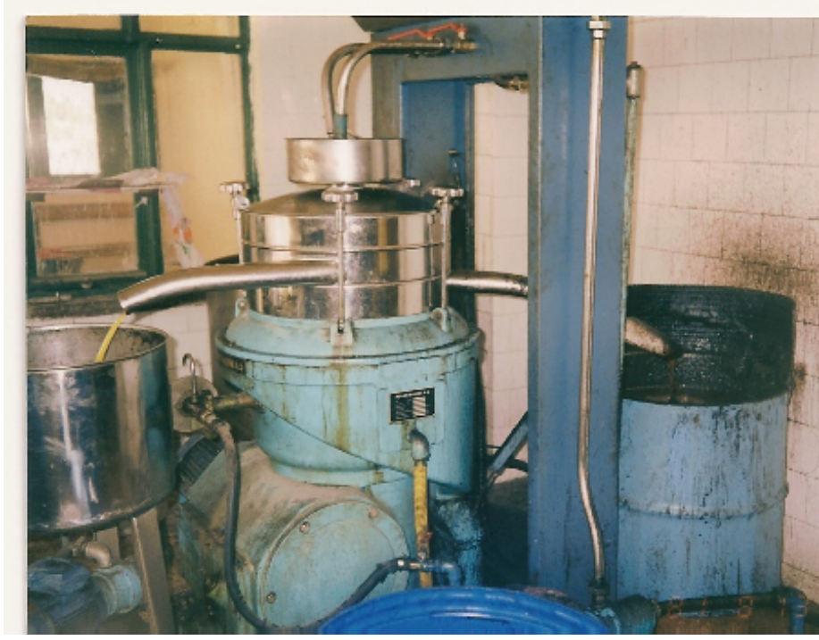
Şekil 2.7 Karasu ve zeytinyağının seperatörde ayrılması (foto: Akgün, 2005)
