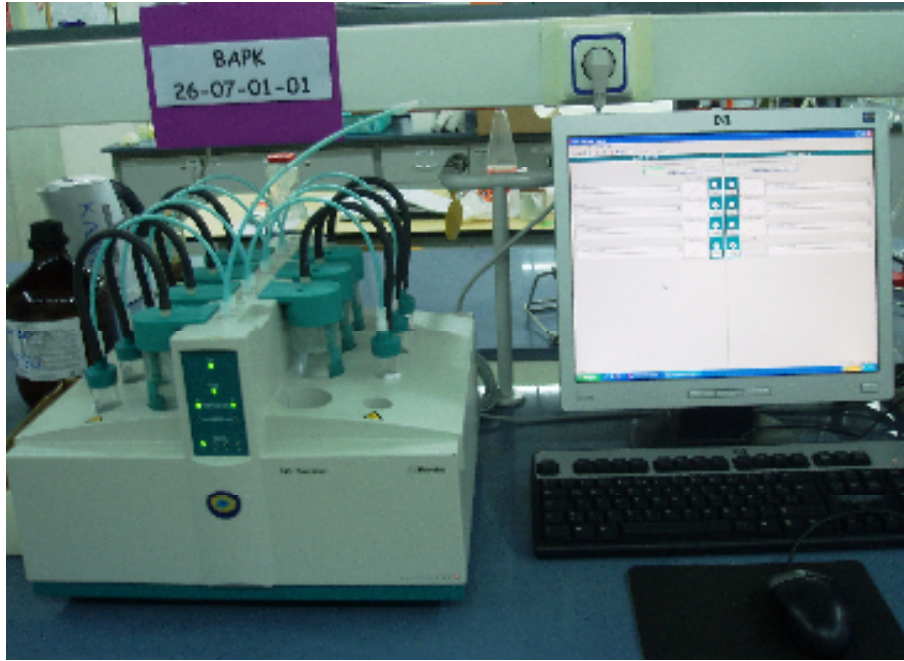
Şekil 6.6 Oksidasyon stabilitesi test cihazı, Rancimat 743
