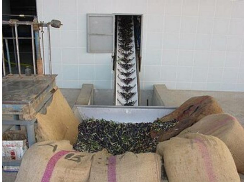
Şekil 2.3 Konveyör ile taşınan zeytinler [2]
