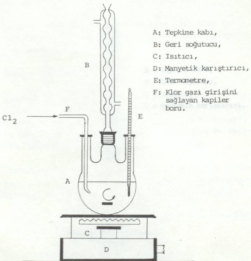
ŞEKİL 3.1. Klörlama işlemlerinin yapıldığı deneysel düzenek.
