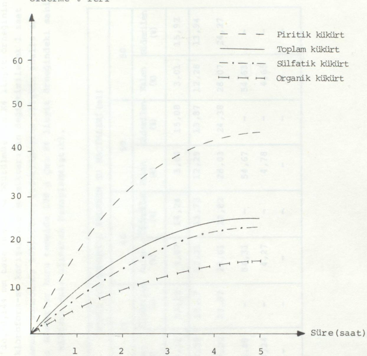
ŞEKİL 3.2.2. Çan K4 linyitörneğinde çözücü olarak su kullanıldığından zamanın değiştirilmesinin kükürt türleri giderimine etkisi.
