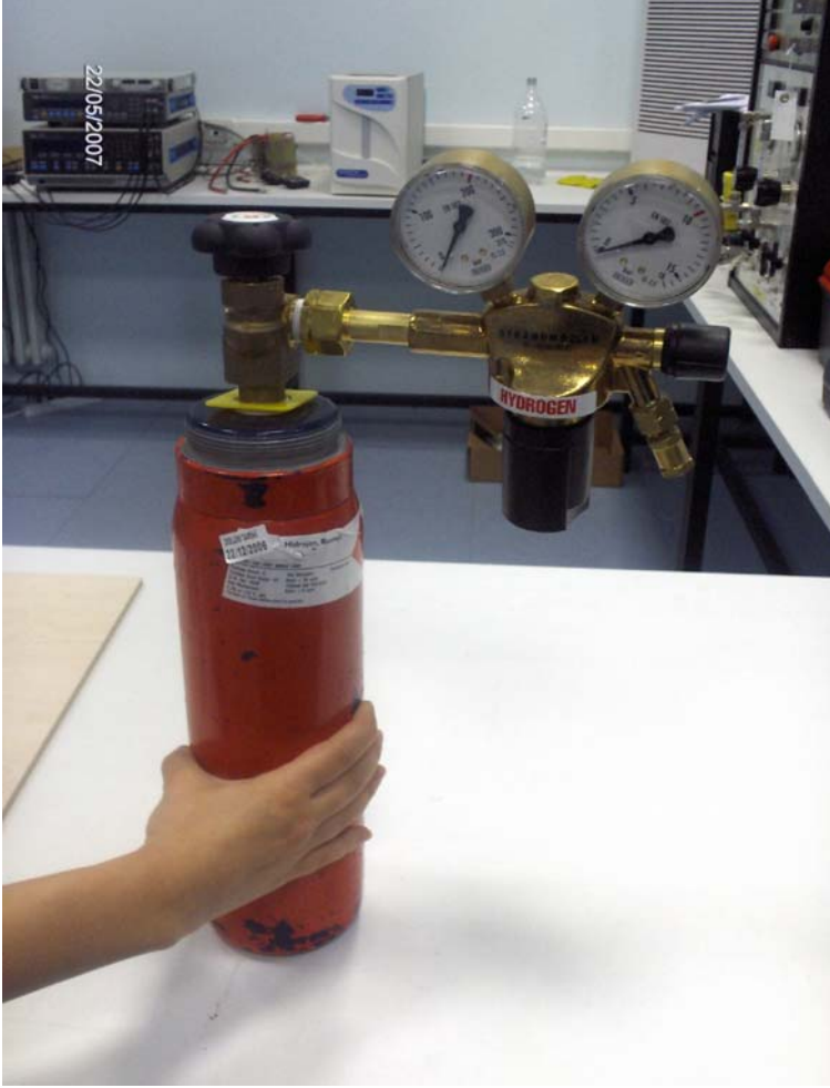
Şekil 4.1: Yüksek basınç altında, çelik tüplerde hidrojen depolanması
