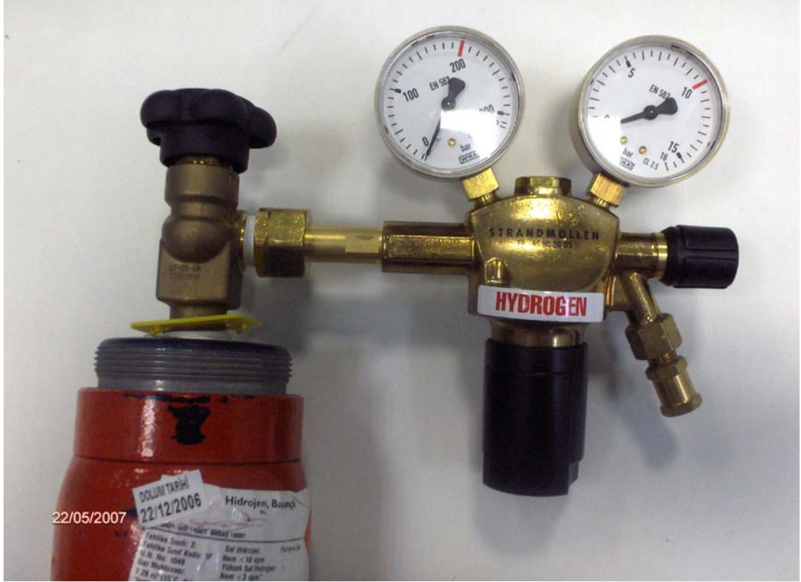
Şekil 4.2 Yüksek basınç altında depolanan hidrojenin, depo çıkışında basıncının düşürülmesi için kullanılan basınç regülatörü
