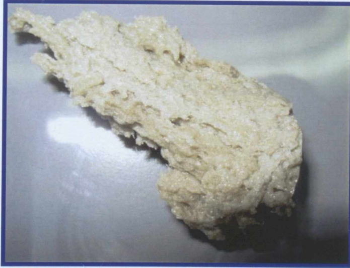
Şekil 6. 21 II. Yüksek alüminalı (Supremax) camın soğuduktan sonraki görüntüsü
