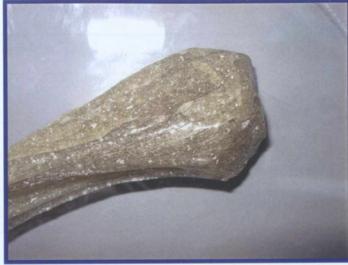
Şekil 6. 10 II. Teknik (Pyrex) cam numunesinin soğuduktan sonraki görüntüsü (Oda sıcaklığında galvaniz saça dökülmüştür)
