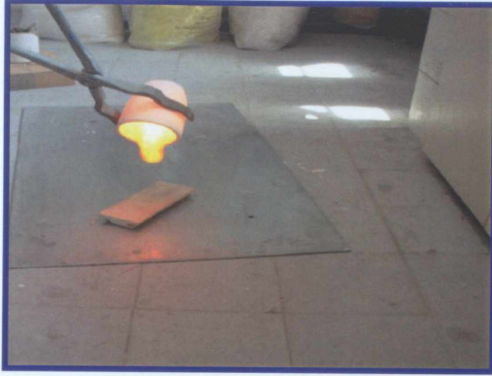
Şekil 6. 17 1300°C'de I. yüksek alüminalı (Supremax) camın ergime görüntüsü
