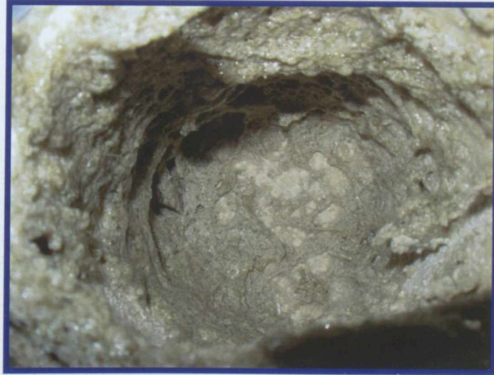
Şekil 6. 20 I. Yüksek alüminalı (Supremax) camın kontrollü soğuduktan sonraki görüntüsü
