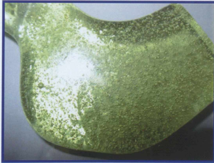
Şekil 6. 32 1250°C 'de III. düz cam üretiminde soğuduktan sonraki görüntüsü (Oda sıcaklığında galvaniz saça dökülmüştür.)
