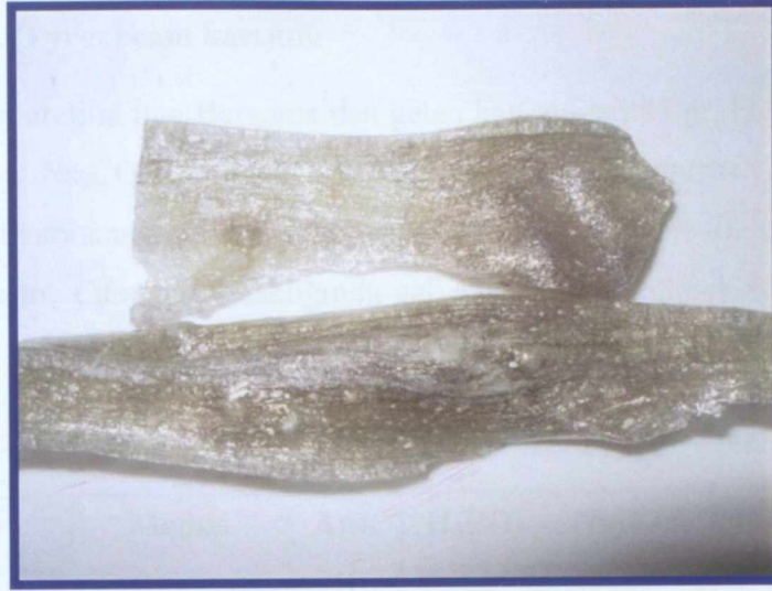
Şekil 6. 7 I.Teknik (Pyrex) camın soğuduktan sonraki görüntüsü (Oda sıcaklığında galvaniz saça dökülmüştür)
