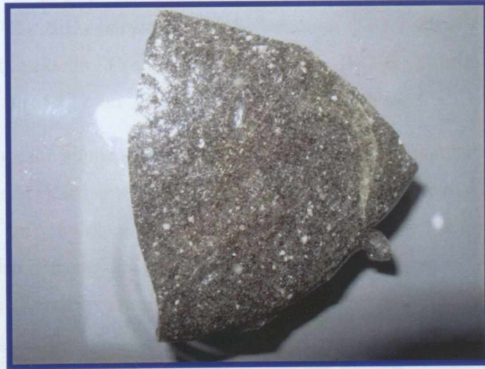
Şekil 6. 11 III. Teknik (Pyrex) camın soğuduktan sonraki görüntüsü (Oda sıcaklığında galvaniz saça dökülmüştür)
