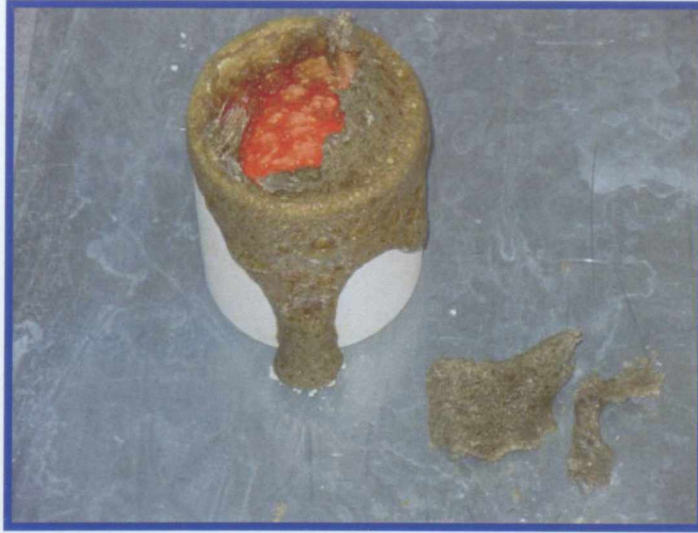
Şekil 6. 16 1270°C'de I. yüksek alüminalı (Supremax) camın ergitme kabının yüzeyi
