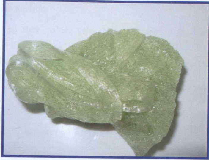
Şekil 6. 30 Galvaniz saça dökülen II. düz camın soğuduktan sonraki görüntüsü
