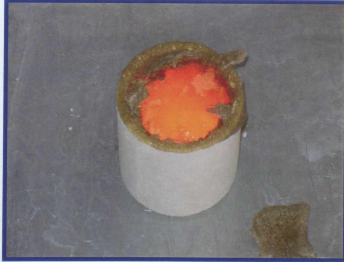
Şekil 6. 18 I. Yüksek alüminalı (Supremax) cam numunesinin soğuma görüntüsü
