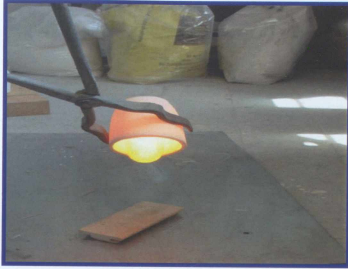
Şekil 6. 28 1215°C 'de II. düz cam numunesi
