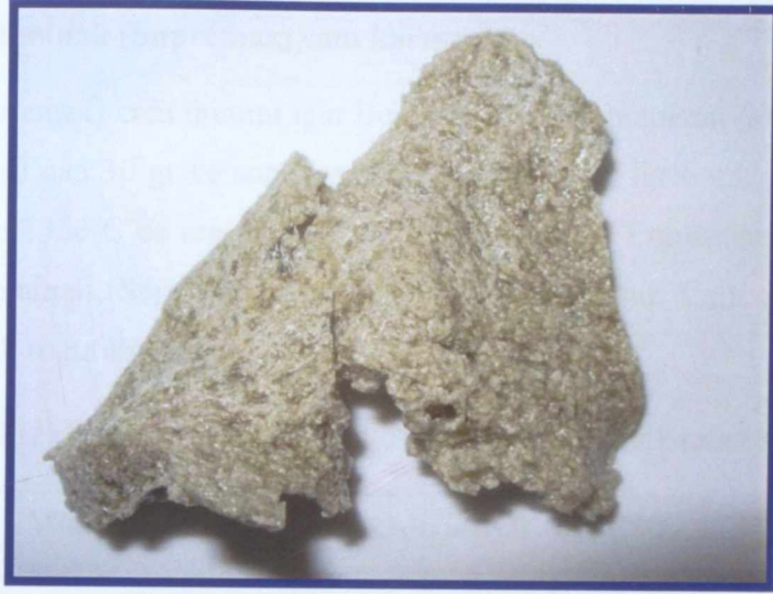
Şekil 6. 19 I. Yüksek alüminalı (Supremax) camın soğuduktan sonraki görüntüsü
