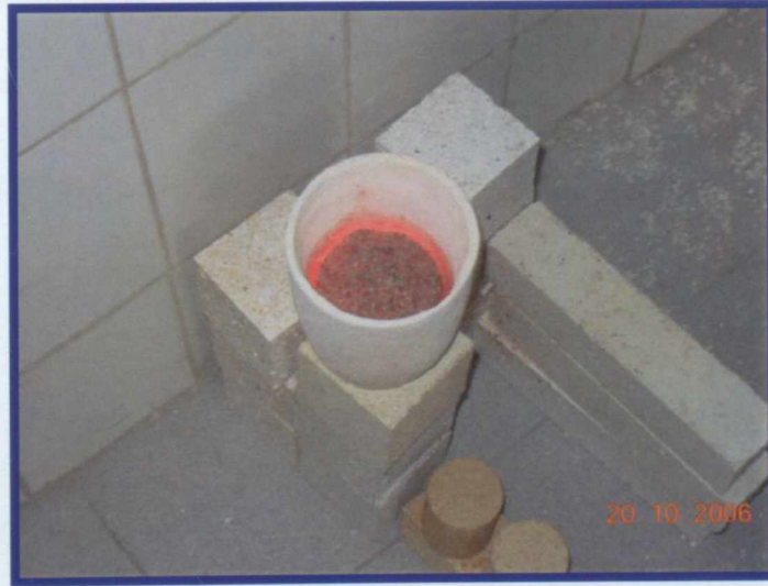
Şekil 6. 9 II. Teknik (Pyrex) cam üretiminde 740°C'deki yüzeydeki tabakalaşma görüntüsü
