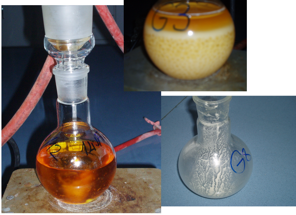
Şekil 5.3 Nötralizasyon aşaması ve tuz oluşumunun gözlenmesi
