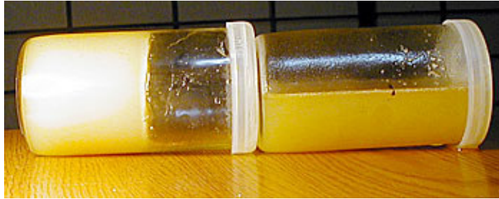
Şekil 2.5 Biodizelde katkı maddesi kullanımı; Katkı maddesi (Wintron X30) katılarak (sağdaki) ve katkı maddesi katılmadan -10^{\circ}\text{C} ’de bekletilen B100 örnekleri [7]
