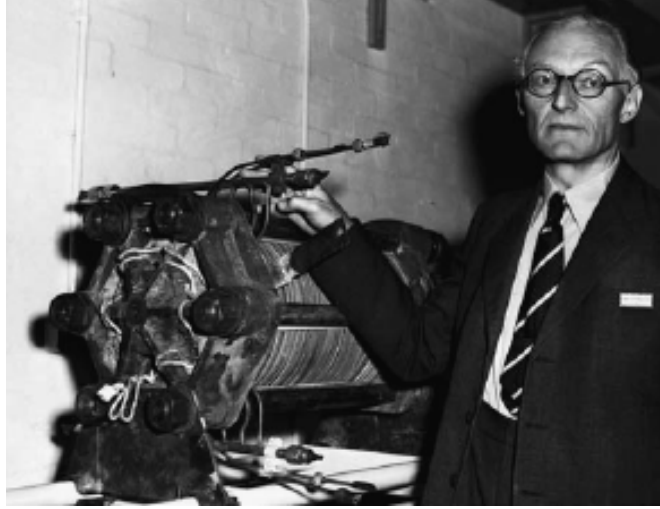
Şekil 3.3. Bacon ve 6 kW'lık 40 hücreli alkali yakıt hücresi (Hoogers, 2003)
