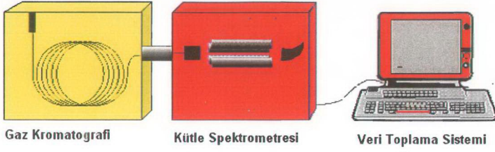
Şekil 2.4 GC-MS'in temel üniteleri [5]
