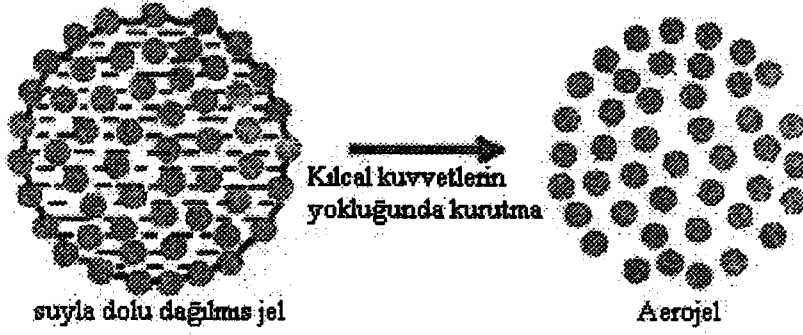
Şekil 6.9 Bir hidrojelden aerojel oluşumu (Le Page,1987)
