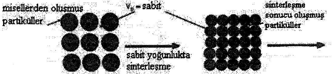
Şekil 6.13 Sabit gözenek hacminde sinterleşme (Le Page,1987)
