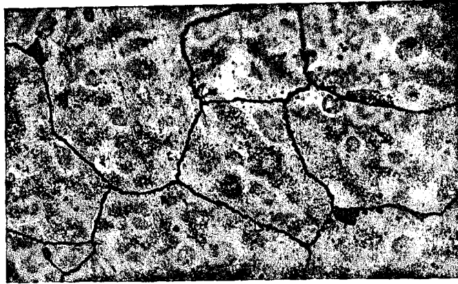
Şekil 5.3. Co-Cr-Mo Alaşımının pH:4'te 150 \mu\text{A}/\text{cm}^2 Akım Yoğunluğunda Farklı Büyütmelerdeki Mikroyapısı
