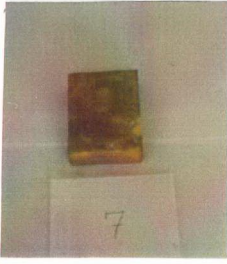
Şekil 6.7. Sorunlu Kilden Elde Edilen Tuğla Örneği (%1 Daha V_2O_5 Katkılı)
