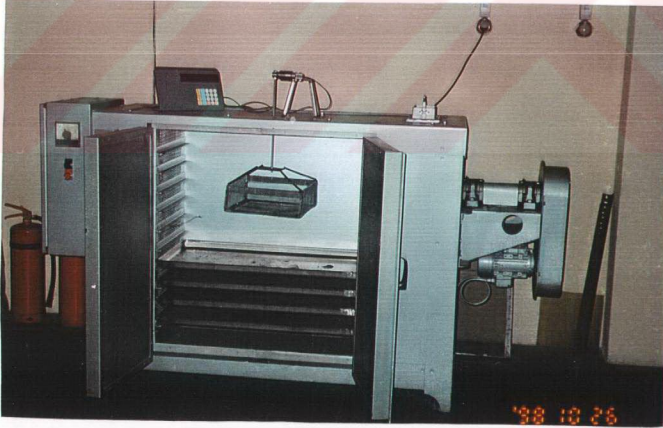
Şekil 4.2 Maydanoz ve dereotunun kurutulmasında kullanılan sıcak havalı kurutucunun genel görünüşü
