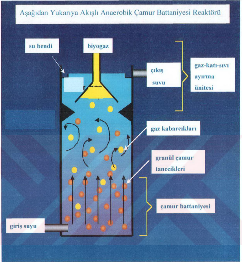
Şekil 3.3 Aşağıdan yukarıya akışlı anaerobik çamur battaniyesi (AAÇB) reaktörü [3]
