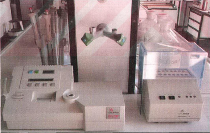
Şekil 4.4 Dr. Lange termostat LT 1W (sağda) ve ISiS 9000 fotometre (solda) Analizler sonucunda Şekil 4.5, 4.6 ve 4.7'deki diyagramlar elde edilmiştir.
