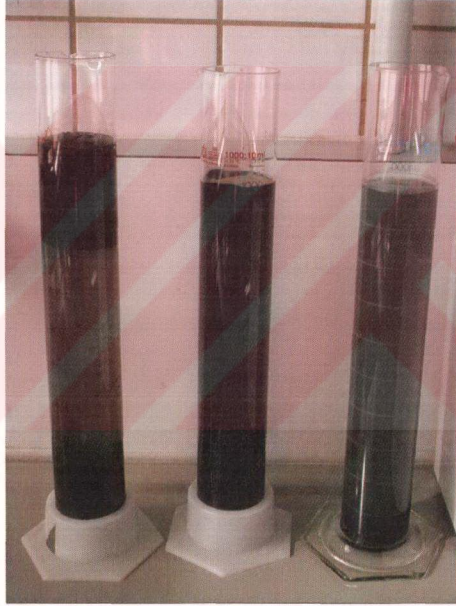
Şekil 4.12 Çamur hacim indeksi analizi (soldan sağa doğru seyreltme oranları; 1:1, 1:2, 1:10)
