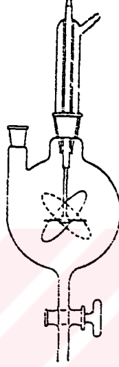
Şekil 2.1. Metalik lityum hazırlanması için düzenek (Coates, G.E., 1967)
