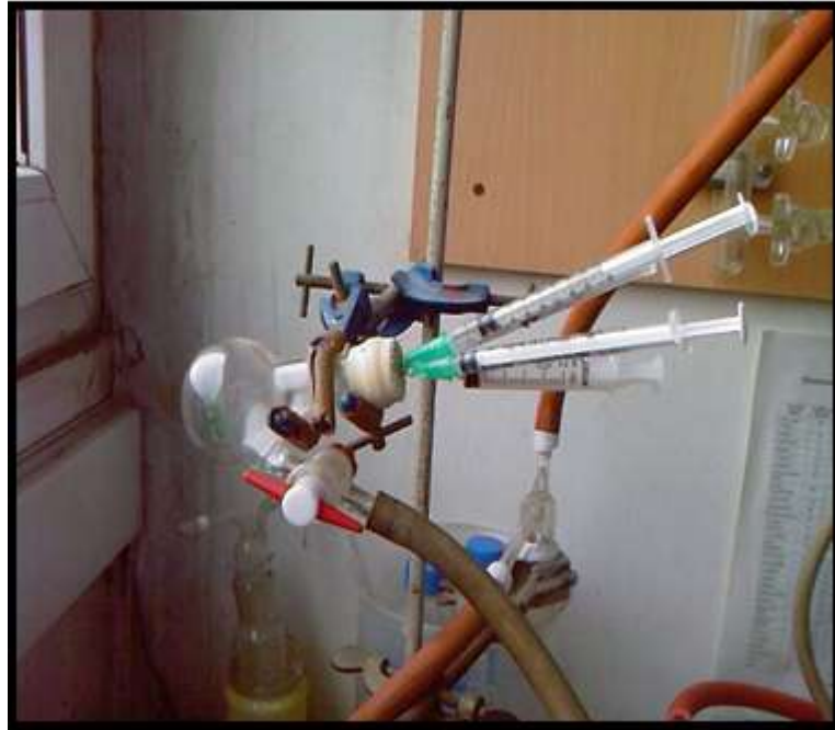
Şekil 6.3 Schlenk sisteminde enjektörlerin azotla yıkanması
