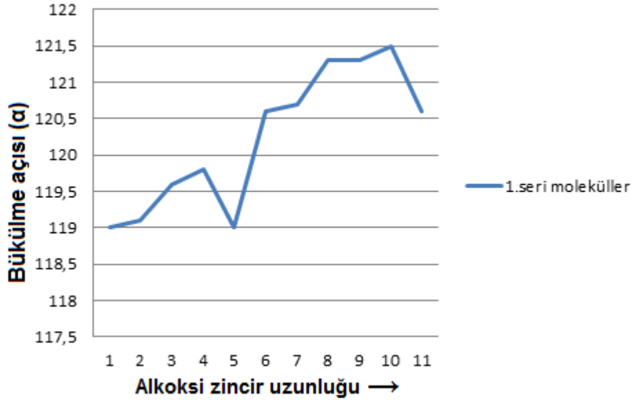
Şekil 6.15 Pbis-n-BB molekül serisinde alkoksi zincir uzunluğunun bükülme açısına etkisi
