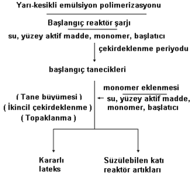
Şekil 3.4 Yarı-kesikli emülsiyon polimerizasyon prosesi
