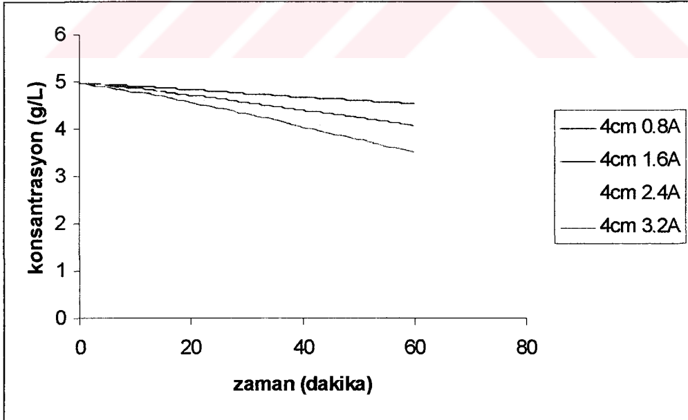
Şekil 4.7 4.96 g/L Cu konsantrasyonlu banyoda 4 cm elektrot mesafesi ile yapılan çalışmalar
