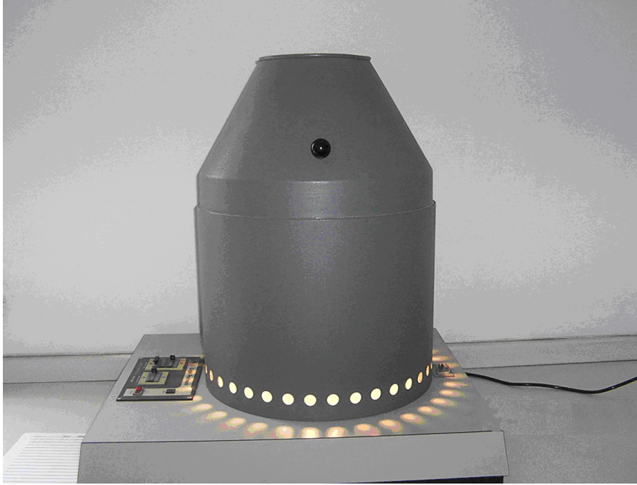
Şekil 2.12 James Heal ışık haslığı test cihazı (Vidinel, 2004).
