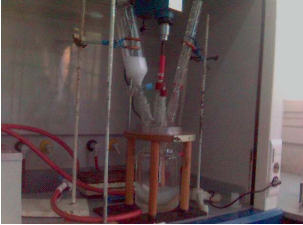
řekil 5.6 Emülsiyon polimerizasyon deney düzeneđi
