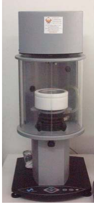
Şekil 5.4 du Nouy Gerilimölçer
