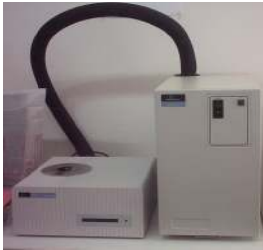
Şekil 5.5 Diferansiyel taramalı kalorimetre
